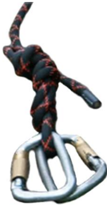
Foto 6 Befestigung der Fanggurtkarabiner am Sicherungsseil
