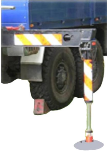
Foto 3: Sachgerechte Sicherung des Fahrzeugs
