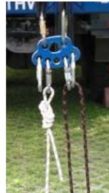
Foto 7 Sicherungsseil in zwei gegensinnigen Karabinern
